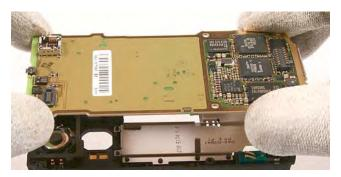
24. Use the tweezers to remove the **Vibra Motor**.
